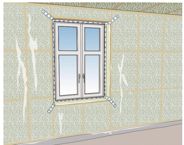
Fig. 1 Icopal Universaltape FT brukt til forsegling av skjøter i dampspærre- eller vindspærresjiktet.
