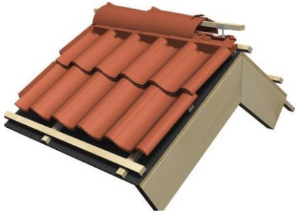
Kuva 9. Harjanliitostilistä käytettäessä asennetaan yllin tiiliruode taulukon 4 tai 5 mukaisesti, ks. sivu 10.
