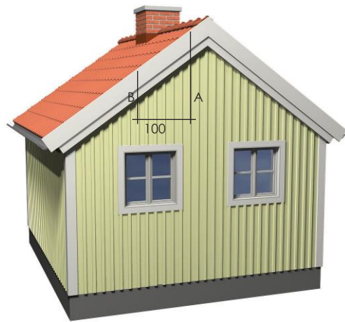
Kuva 1. Talon katon kaltevuus voidaan määrittää vähentämällä mitasta A mita B
