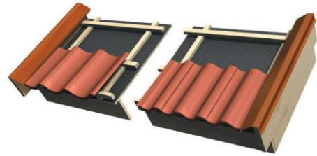
Kuva 6. Rakennusleveys Hansa-tiilille on n. 211 mm ja Tvilling-tiilille 346 mm. Ota huomioon, että tuulilevy tulee tiilien yläpuolelle, siten että vesi menee alas tiilen aallon pohjaa pitkin.
