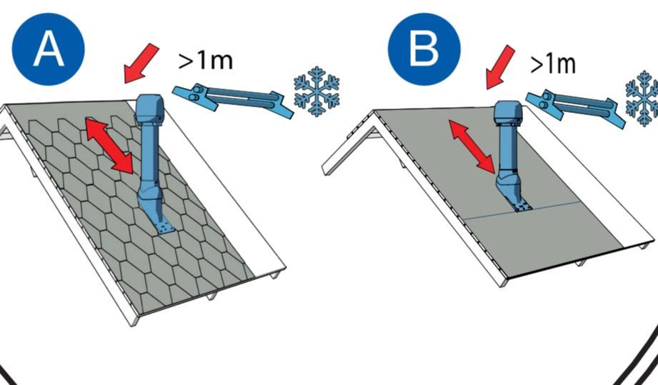
Käytä bitumimassaa, joka soveltuu muovien ja kattohuopien ja -kermien liimamiseen ja tiivistämiseen | Använd bitumenmassa lämplig för sammalfogning och tätning av plast och takpapp och lister | Use bituminous mass suitable for bonding and sealing plastic and roofing felts and strips | Применять герметики для пластика и битумных материалов | Użyj masy bitomicznej odpowiedniej do łączenia i klejenia pokryć dachowych i listew.
