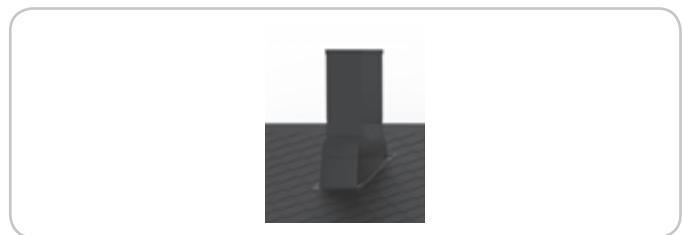
Vaihtoehto I (Vilpe): Vesikaton läpivienti huopakatteelle Sopii Rondo Plus yksihormiselle (harkon koko 320 - 370 mm) ja maksimi pituus 1720 mm. Sisältää muovisen piippuläpiviennin, ympärystellin, ruuvit ja asennusohjeen. Soveltuu kattokaltevuudelle 10-45 °. Värit: musta ja tumman harmaa.
