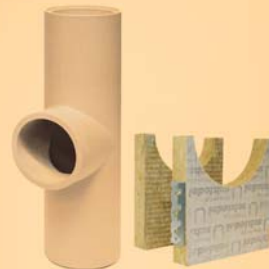
8 Тройник для подключения потребителя. Высота: 660 мм. Внутренний размер дымового выхода равен отверстию дымового канала. Теплоизоляция для соединительных элементов + крепления.
