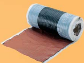
14 Уплотнительная лента Wakaflex из полиизобутилена, армированная алюминиевой сеткой с полоской бутилового клея с обеих сторон.
