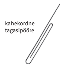
Joon. 16 Plekiserva tagasipööre. Mastaap 1:1
